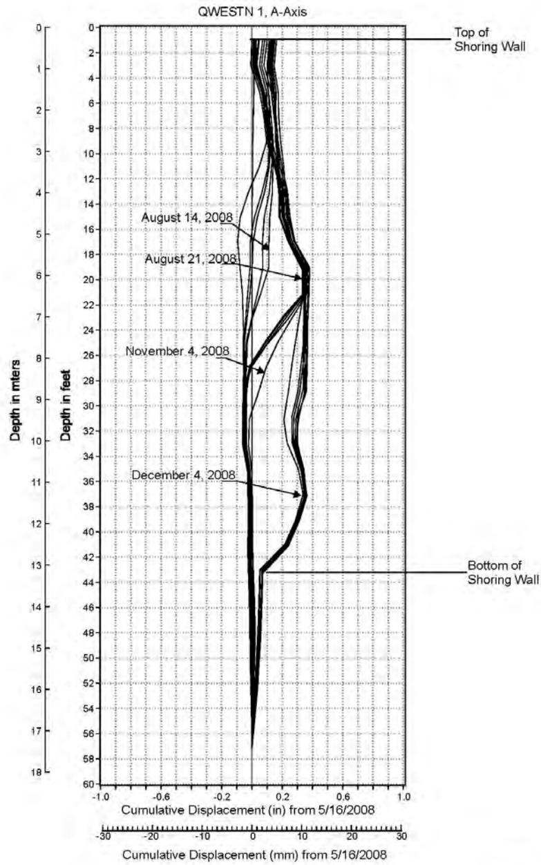
**Figure 8 - Inclinometer Results**
